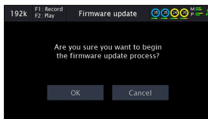
アップデートの適用中は、Mesa またはコンピューターの電源を切らないようにディスプレイに示されます。完了したら、背面の電源スイッチで Mesa の電源をオフにするように指示されます。電源を入れ直すと、新しいファームウェアが有効になります。
