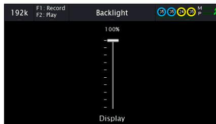
**Backlight:** このページには、Mesa ディスプレイのバックライトの明るさを調節するスライダーがあります。デフォルトは 100% ですが、下げて明るさを下げることができます。バックライトページがアクティブな間、ロータリーエンコーダーでバックライトスライダーを操作できます。
