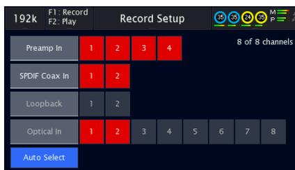
**Record Setup:** Mesa は、録音時に接続されている入力に基づいて、microSD カードに録音するチャンネルを自動で選択します。録音する入力チャンネルを手動で指定したい場合は、「Record Setup」ページで選択できます。プリアンプ、SPDIF 同軸、ループバック、光チャンネルの任意の組み合わせから選択できます。
