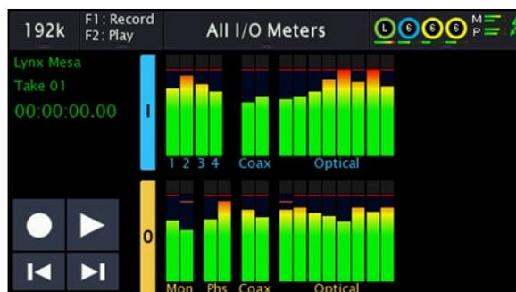
Mesa を起動すると、「All I/O Meters」ページが表示されます。このページは、Mesa の入出力に信号が供給されている場所を一目で確認できるように設計されています。メーターの上段は入力、下段は出力を表します。デフォルトでは、物理的な入出力のみが表示されます。ユーザーは、このページにコンピュータとの間の信号も表示するように設定できます。このオプションについては、セクション 3.2.5 で詳しく説明します。
