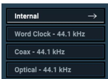
**Sync Source:** このメニューには、Mesa のすべての同期ソースオプション(内部、ワードクロック、同軸、光)が表示されます。有効なクロックソースが接続されているソースのみが選択可能です。特定の入力に有効な信号が存在しない場合は、グレー表示されます。有効なクロックソースには、その入力を受信されているサンプルレートが表示されます。
