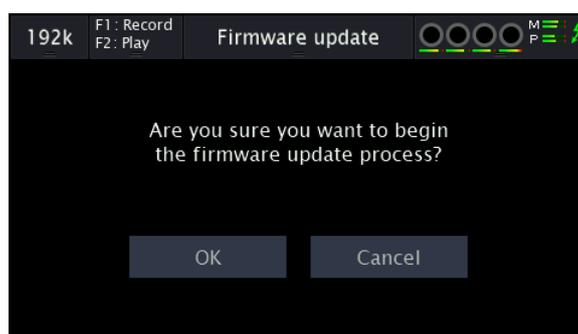
OK ボタンを押すと、ファームウェアのアップデートは、前のセクションで説明したのと同じ 4 つの段階（消去、プログラミング、検証、完了）を経て進行します。プログラミングが完了すると、背面パネルの電源スイッチを使って Mesa の電源を切るように指示されます。電源を切ると、新しいファームウェアが有効になります。
