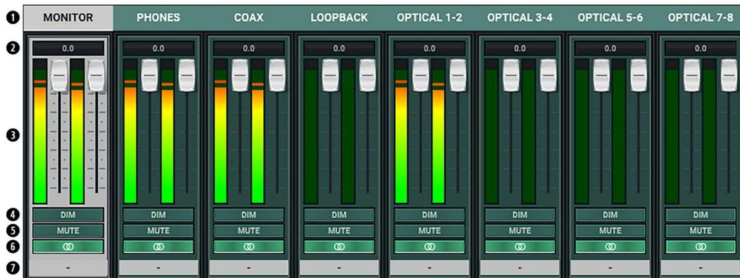
出力パネルでは、メーターの確認、出力レベルの調整、ミュートとディムの適用、チャンネルのカスタムラベルの設定が行えます。さらに、出力パネルは信号のルーティングやミラーリングの開始点となります。これについては、このセクションで詳しく説明します。まずは、ここで表示される各コントロールを見ていきましょう。
