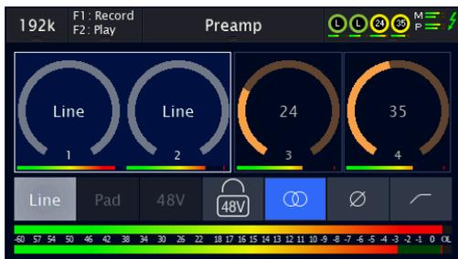
入力で Hi-Z が選択されている場合、パッドと 48V は適用されず、グレー表示されます。
