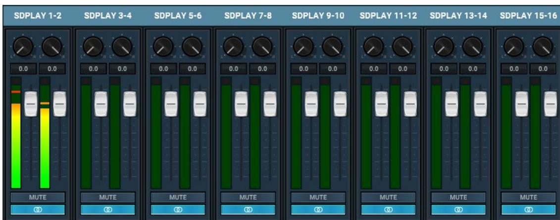
出力パネルの上には SD Play パネルがあります。microSD カードに録音されたトラックを Mesa の任意の出力に送ることができます。デフォルトでは、SD カードのトラックは Monitor 出力と Phones 出力から再生されますが、必要に応じてカスタマイズできます。
