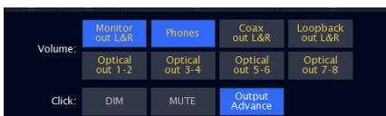
Mesa 前面の Mute ボタンは、デフォルトでは全出力をミュートします。ユーザーによっては、この動作を変更したい場合もあるでしょう。ここでは、その動作をコントロールできます。このグローバルミュートから個々の出力を除外したり、「Current Output」のみにミュートを適用したりできます。クリック(上記)が「Output Advance」に設定されている場合、ミュートボタンはロータリーエンコーダーの現在の出力に追従します。
