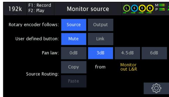
Rotary encoder follows は、ソースまたは出力を選択します。ロータリーエンコーダーで入力ソースのモニタリングボリュームをコントロールするか、出力ソースページで選択した出力ボリュームをコントロールするかを決定します。
