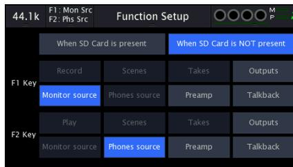
**Function Setu:** 2 つのファンクションボタンの押下時の動作を設定できます。SD カードが挿入されている場合、または挿入されていない場合に、これらの操作を実行するかどうかを選択できます。
