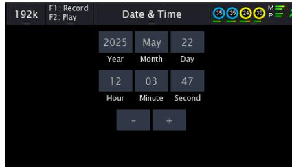
**Date & Time:** microSD カードへの録音のタイムスタンプに使用する、Mesa の内部クロックを設定します。Mesa Remote を使用する場合、コンピューターの日付と時刻を Mesa に送信してこの値を設定できます。セクション 4.1 を参照してください。
