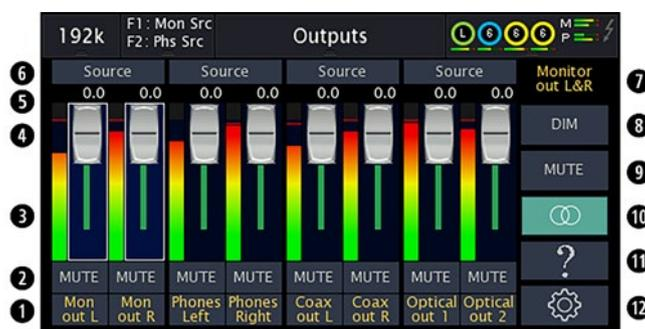
このページでは、Mesa の出力を俯瞰的に確認でき、出力のアッテネート、ソースの割り当て、その他のパラメーターの調整が可能です。多くのユーザーは入力信号をレコーディングソフトウェアでモニタリングするため、デフォルト設定を変更する必要はないでしょう。しかし、ゼロレイテンシーのハードウェアモニタリング、複数の出力への信号のミラーリング、その他高度な機能の設定などを行いたい場合は、このページから変更を加えるのが良いでしょう。
