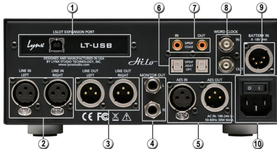
**① USB：**コンピューターと接続をするUSB 2.0仕様の端子です。最大で16チャンネルの同時入出力を扱います。市販のUSBケーブルを使用する場合、USB 2.0準拠、最長5m (16フィート) までのものを使用します。
