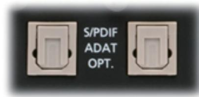
TOSLINK (光角形) コネクタのデジタルフォーマットを設定します。S/PDIFは一般的なステレオのデジタル信号を扱います。ADATは、48kHz/44.1kHz時に最大で8チャンネルの転送を行うマルチチャンネルのデジタル形式です。88.2kHzと96kHz時では、S/MUX規格に準じた4チャンネルのデジタル信号を扱います。176.4/192kHzは、ADAT S/MUXに対応しませんので、このレートをADATモードで扱うことはできません。
