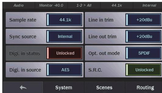
**Sample Rate (サンプルレート)** : サンプルレートの設定をします。画面には現在の動作クロックが表示されます。外部クロックに同期している場合はそのクロックに基づいたサンプルレート、内部クロックの場合はこの画面、あるいはDAWソフトウェアで設定したサンプルレートを表示します。
