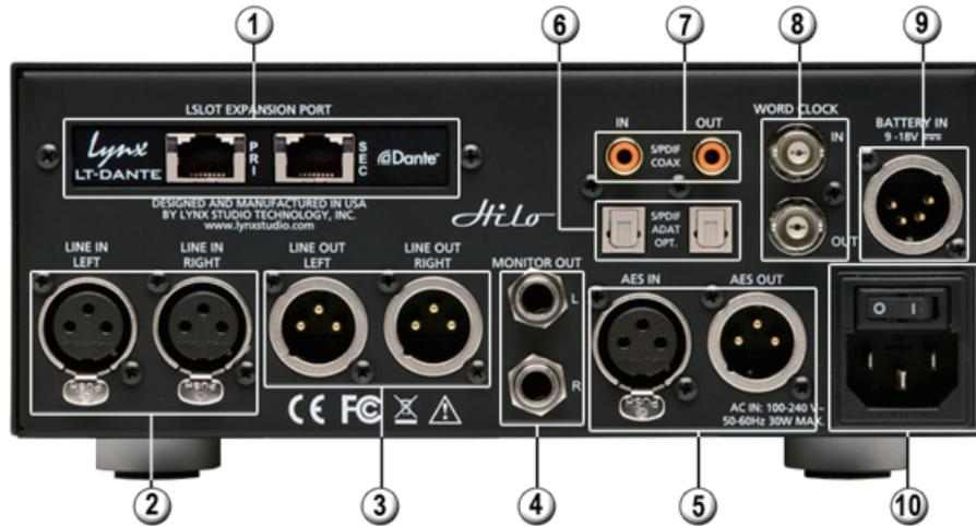
**① Dante:** Danteネットワークと接続するための端子です。(RJ45/Ethernet) 市販のCAT5eまたはCAT6規格のイーサネットケーブルで接続可能です。Danteネットワークでは、ケーブルの品質次第で、機器間の距離を最大100mまで離すことが可能です。3つの以上のデバイスでネットワークを構築する場合、Ethernetスイッチを用いた"スター"型のネットワーク構築をお勧めします。Hilo Danteは、コンピューターによるルーティング操作が可能です。この場合、専用のソフトウェアDante Controllerで行います。Hilo Danteをオーディオインターフェイスとして使用する場合、コンピューターにDante Virtual Soundcardをインストールして、イーサネットポートを通じてオーディオ信号をDanteネットワーク/Hiloに送れるようにします。
