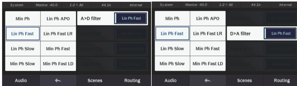
このオプションにより、ライン入力とライン出力のローパスフィルターオプションを選択することができます。A>D ボタンは、ライン入力アナログ・デジタル・コンバーターのアンチエイリアシング・フィルターを選択します。D>Aボタンは、ライン出力のデジタル・アナログ・コンバーターのアンチエイジング・フィルターを選択します。
