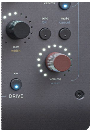
図 4. Volume/Select でスクロールし、Solo/OK で確定するか、Mute/Cancelでキャンセルします。
