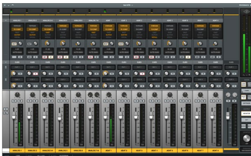
16 個のプリアンプ入力を備えた ADAT エクスパンダーユニット 1 台を備えた UAD コンソール
