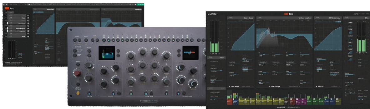
図 1. Console 1 の 3 つの部分です。左から、プラグインウィンドウ、ハードウェア、オンスクリーンディスプレイアプリケーションです。
