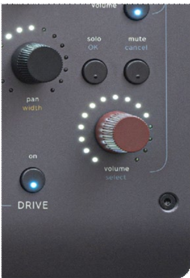
図 4. Volume/Select でスクロールし、Solo/OK で確定するか、Mute/Cancelでキャンセルします。
