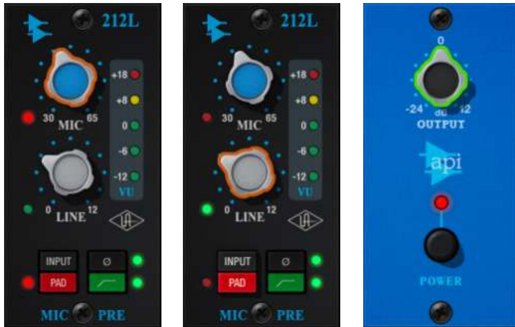
Unisonゲインステージモードの時に色違いで表示されるアウトライン化されたゲインコントロール
