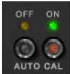
Studer A800にはバイアス、HFレコードEQとシンク/リプロEQのパラメーターがあります。ハードウェアテープマシンでは、テープタイプ、テープスピード、またはエンファシスEQを変更する際にこのキャリブレーションコントロールは調整されます。
