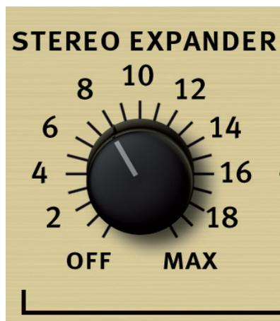
“STEREO EXPANDER”はより広いステレオイメージを作り出します。当初、左側、または右側のステレオイメージに置かれている信号をダブリングし、フェイズを反転させ、逆のチャンネルと合わせステレオイメージを改善します。ステレオイメージがスピーカー面から聴こえてくるときオリジナル信号よりも良い感覚を得られます。ステレオイメージの中央に置かれるモノ信号はプロセッシング中に減少します。セッティングは6~14の間の数値を推奨します。高いセッティングでのソース信号の性質を考慮してゴニオメーター(角度計)をチェックして信号のモノラル互換性を確認する必要があります。
