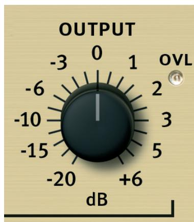
“OUTPUT”は、アウトプットレベルを-20dB~+6dBの間で増減させます。0dB マークが中央に設定されています。一般的に Vitalizer によるプロセッシングがレベルを上げる傾向にあることを考えるとレベルを減らす必要があります。ドライブコントロールのインプットレベルを0dBに設定する場合、フィルタリングにとって良いスタートポイントになります。プロセッシングの後は間違いなくレベルが上がる傾向にあるので、アウトプットレベルで調節を行なってください。
