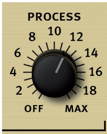
“BASS”と“MID-HI TUNE”は2つの異なるシグナルパスで動作します。オリジナルシグナルとプロセッシングした両方のシグナルはアウトプットでミックスされます。“PROCESS”は、使用する処理したシグナルの量を決定します。すなわち、“BASS”と“MID-HI TUNE”フィルターによって作られたエフェクトの強さを意味します。さらに“PROCESS”は中域のダンピングの強さもコントロールし、(前のセクションを参照)中域は高い“PROCESS”セッティングで減衰させることができます。“MID-HI TUNE”によって選択したカットオフ周波数以下の周波数は影響を受けません。
