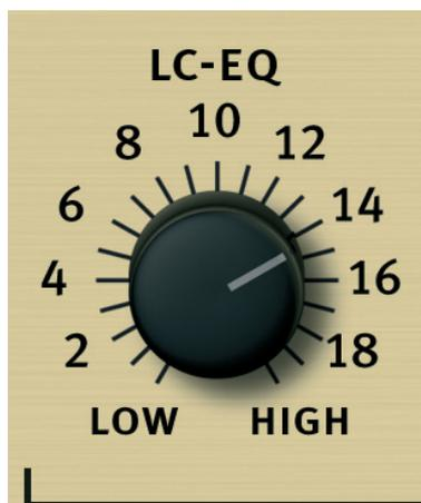
ハイフリーケンシーフィルターは、ボードバンドフィルターも兼ねており、ボーカルにスペシャルな存在感とシャープさを加えるために中域のコントロールをします。影響を与える周波数は 2kHz から 20kHz の間です。“INTENSITY”は、“LC-EQ”のかかり具合の強さをコントロールします。“LC-EQ”はハードウェアのハイフリーケンシーフィルターから名付けられ、パッシブタイプのフィルターです。コイルフィルターは、インダクターフィルターで、インダクタンスの記号は“L”で、コイルフィルターの省略形は“LC”となります。(C はコンデンサーの略) このタイプのフィルターは、心地の良いソフトな音の特徴です。より安価なレジスターコンデンサー“RC”の出現によって入れ替えられる
