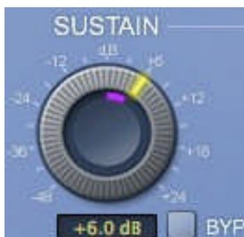
ゲインは、dB 値で設定し、プロファイル・セッティングに関係なく選択した設定を超えることはありません。ゲイン・エンベロープの現在のレベルは、各レベル・コントロール内の円形のメーターに表示されます。
