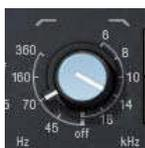
独立したローとハイ・カット・フィルターはロー・バンドの右側にある二重同心のノブでコントロールを行います。コントロールは、それぞれのカット・フィルターの周波数を指定します。
