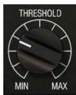
連続可変コントロールは、チャンネルに適用するコンプレッションの量を決定します。スレッシュホールドを下げ、コンプレッションを高めるにはスレッシュホールドの値を MIN（反時計回り）方向に回します。
