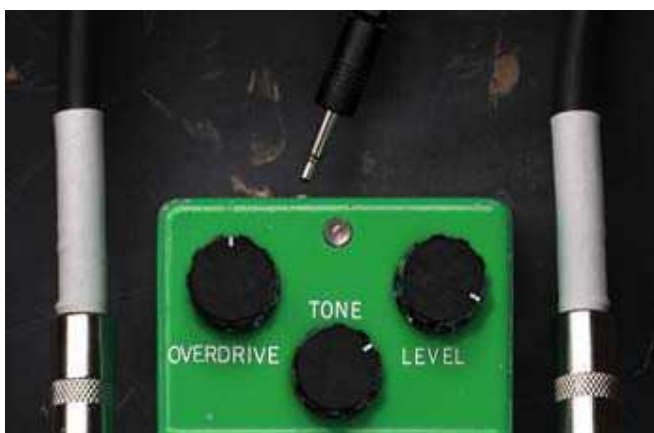
図 61. 電源ケーブルを抜くとトゥルーバイパス・モード
