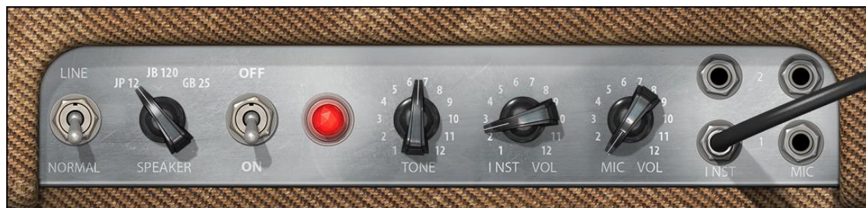
アンプ・パネルのコントロール類
