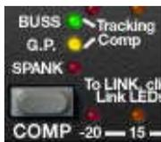
「COMP」ボタンは、どのコンプレッサーが動作中か設定します。モードの説明については「コンプレッサー・プロセッサー」の項を参照して下さい。スパイク・モードは合計で7つのコンプレッサー・モードのうち、3つのモードと結合して使用することが可能です。
