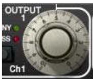
アウトプット・ノブはプラグインから出力される信号のレベルをコントロールします。
