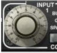
インプット・ノブは、プラグインに使用する信号のレベルを設定します。高いインプット・レベルはサチュレーションを起こします。クリップした場合、(LEDに示されるように)0VUよりも上のレベルでは劇的に高いディストーション・サウンドを提供します。下記のTHDインジケータを参照して下さい。
