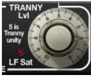
このコントロールはトランニー処理(詳細については「トランニー・プロセッサー」の項を参照して下さい)の量を設定します。高い値はトランニー効果を強くします。トランニー・レベルを上げるということはシグナルTHD(「THDインジケータ」の項を参照して下さい)とウォームス・プロセッサーの感度を上げることになります。5の値は統一セッティングです。
