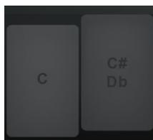
キーボードのノートがオフに設定されている場合、そのノートはグレーで表示され、そのノートにもっとも近い入力ピッチは、次に近いスケールのノートに調整されます。
