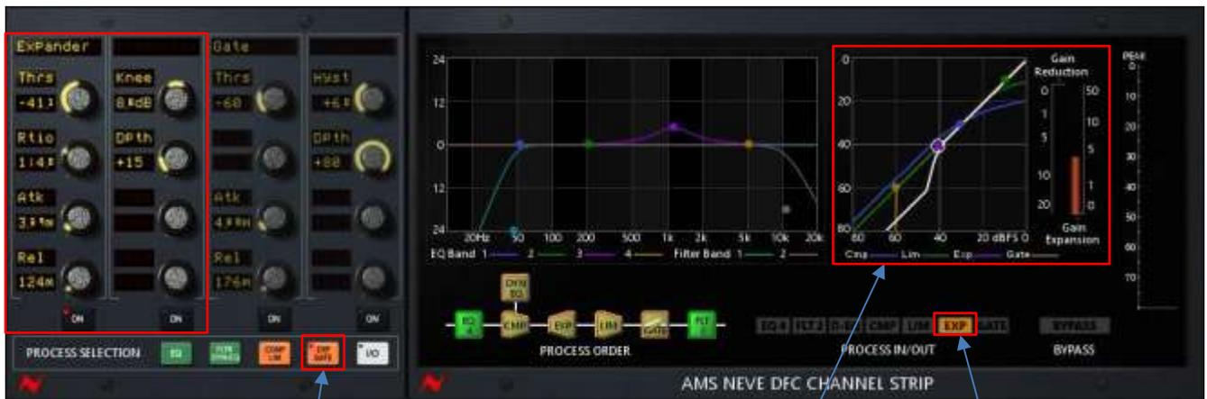
エキスパンダーコントロールにアクセスするには、Exp/Gateプロセスセレクション・ボタンを選択してください。その後、Chan-Quadの最初の2つのストリップがエキスパンダーに割り当てられます。最初のオンボタンは、エキスパンダーのイン/アウト・コントロールに割り当てられています。
