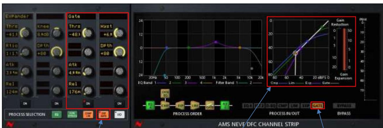
ゲートコントロールにアクセスするには、Exp/Gateプロセスセレクション・ボタンを選択してください。その後、Chan-Quadの3番目と4番目のストリップがゲートに割り当てられます。3番目のオンボタンは、ゲートのイン/アウト・コントロールに割り当てられています。
