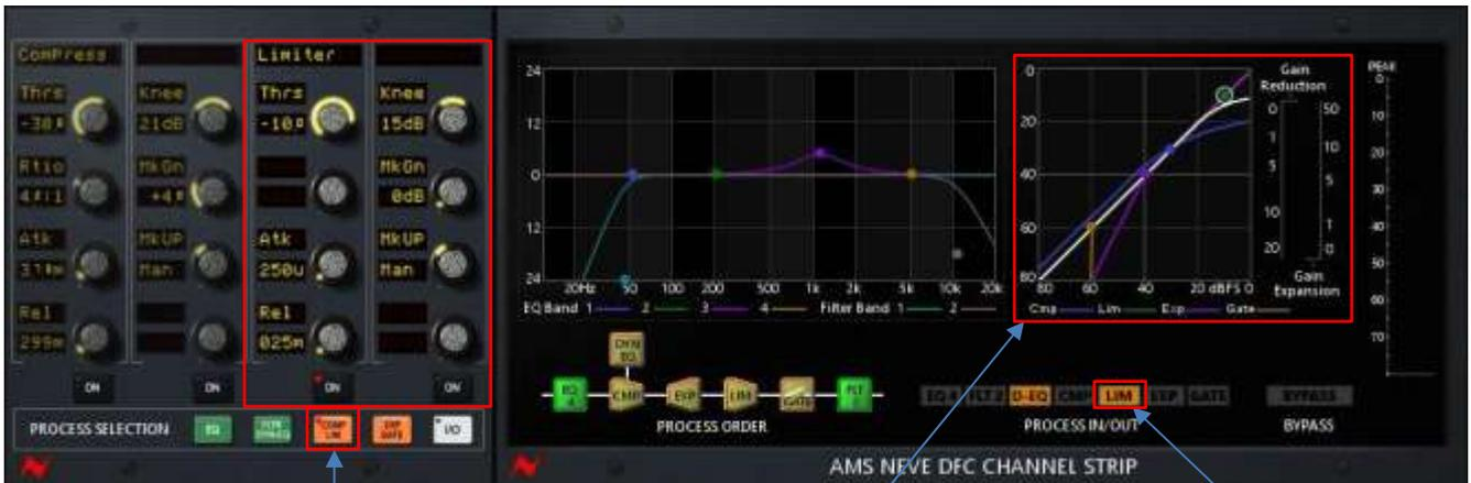
リミッターコントロールにアクセスするには、COMP/ LIMプロセスセレクション・ボタンを選択してください。その後、Chan-Quadの3番目と4番目のストリップがリミッターに割り当てられます。3番目のオンボタンは、コンプレッサーのイン/アウト・コントロールに割り当てられています。
