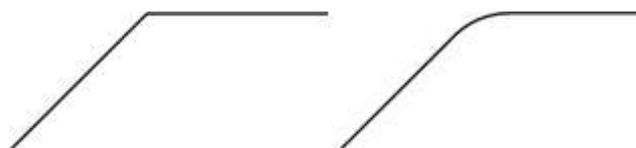
アタックタイム・コントロールは、コンプレッサーがゲインリダクションを適用するまでのスピードを設定します。最小値（70μs）では、ゲインリダクションはより聴こえやすい効果で非常に速く適用され、最大値（50ms）では、ゲインの変化は徐々に適用されます。
