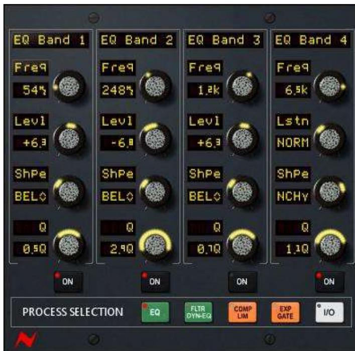
2. EQ、ダイナミクス、インタラクティブプロセスオーダー・メーター、インタラクティブプロセス・イン/アウト・ディスプレイ、バイパス、出力メーター用のインタラクティブグラフを含むDFC“TFTメーターパネル”
