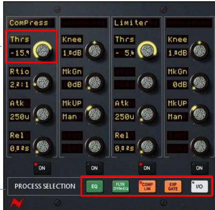
5つのプロセスセクション・ボタンのいずれかを押すと、そのプロセッサのコントロールとオンボタンにアサインされます。
