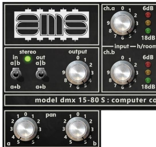
モノラルで使用時、このスイッチは強制的に“a + b”になります。チャンネルが1つだけ必要な場合は、未使用のチャンネルインプットゲインをゼロに設定できます。
