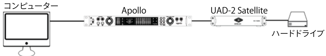
ディジーチェーンによるFireWire接続
