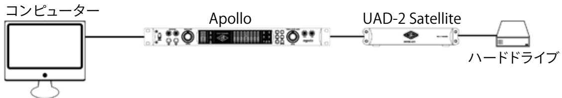
ディジーチェーンによるFireWire接続
