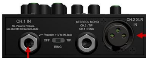
CH.2 IN コンデンサーマイク (ファンタム電源48V供給可)
