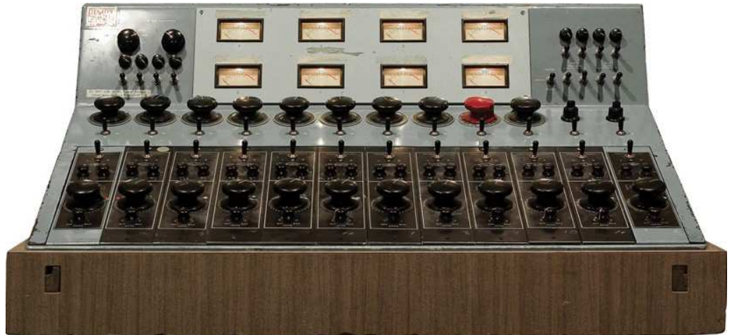
12台のビンテージ UA 610-A プリアンプを搭載した オリジナル Wally Heider "Green Board" コンソール
