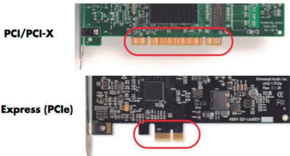
UAD-2 PCIeカードはその名が示す通り、PCIe規格対応です。PCIやPCI-Xスロットと間違えないようご注意下さい。
