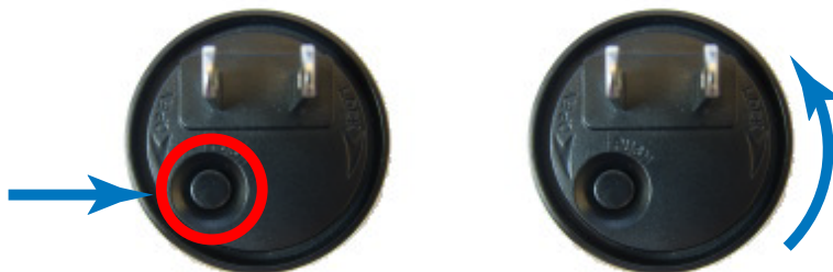
ACアダプターのソケットを外す方法 *一例です。モデルによって方法が異なります。
