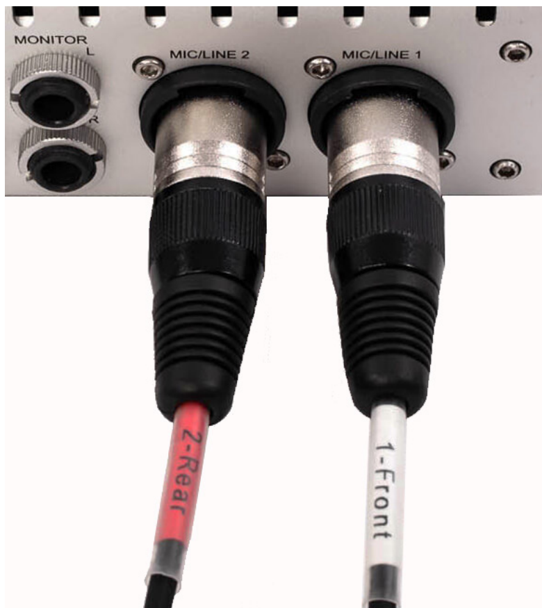
図2-1 Sphereマイクとプリアンプの接続
