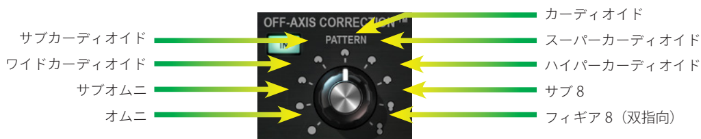
図6-1 OFF-AXIS CORRECTIONのパターンパラメーター
