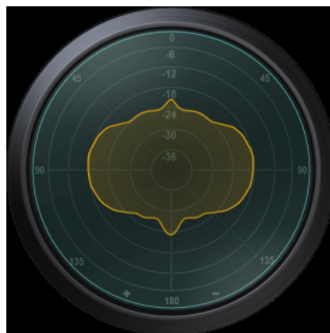
図3-5 ポラーメーター (全方向から信号を拾っている状態)
