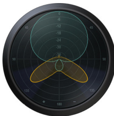
図3-4 ポラーメーター (カーディオイドパターンと135度のオフアキスからの信号を拾っている状態)
