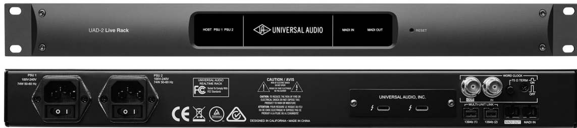
1Uラック筐体の「UAD-2 Live Rack」。背面にはライブ・コンソールと接続するためのMADI端子、コントロール用コンピューターを接続するためのThunderbolt端子、ワード・クロック入出力端子などを装備。電源が二重化されているのも大きな特徴だ
