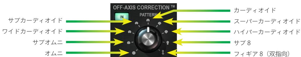
図3-3 OFF-AXIS CORRECTIONのパターンパラメーター (とINボタン)
