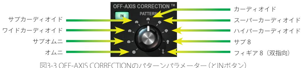
図3-3 OFF-AXIS CORRECTIONのパターンパラメーター(とINボタン)
