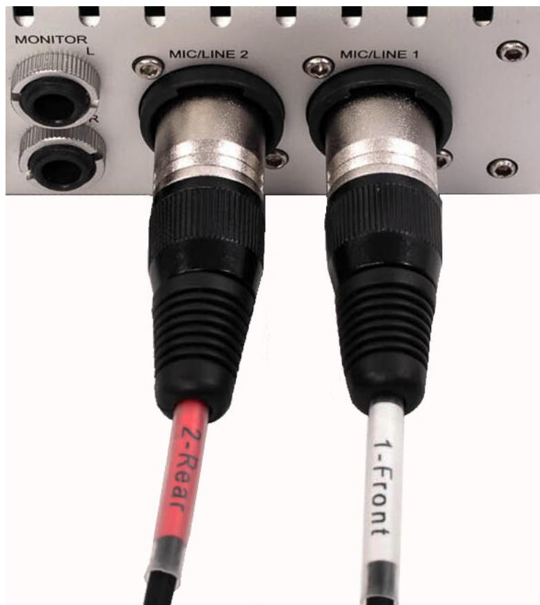
図2-1 Sphereマイクとプリアンプの接続
