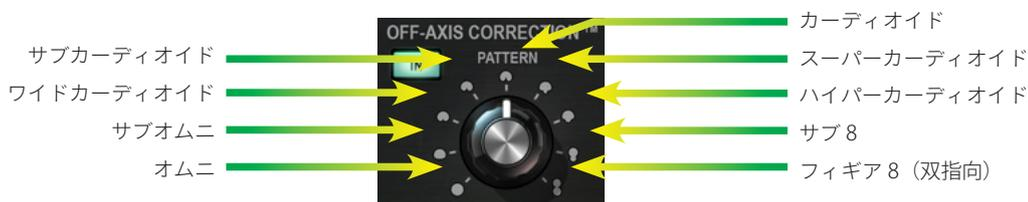
図6-1 OFF-AXIS CORRECTIONのパターンパラメーター
