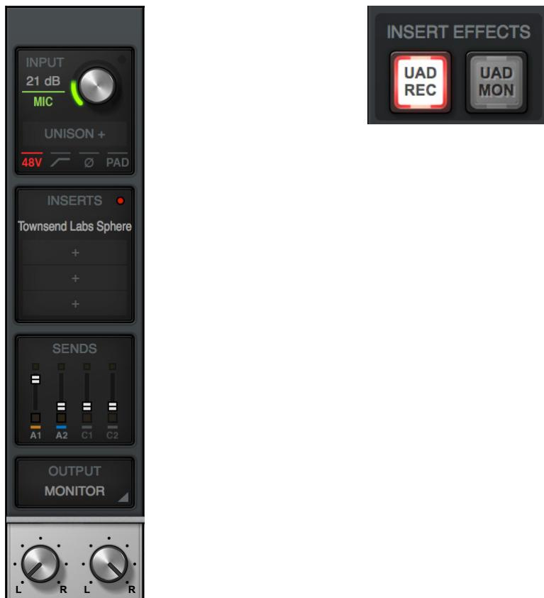
図2-3 Apollo Consoleのチャンネルリストリップ画面(右) - Sphereプラグインが最初のスロットに挿入されている状態
