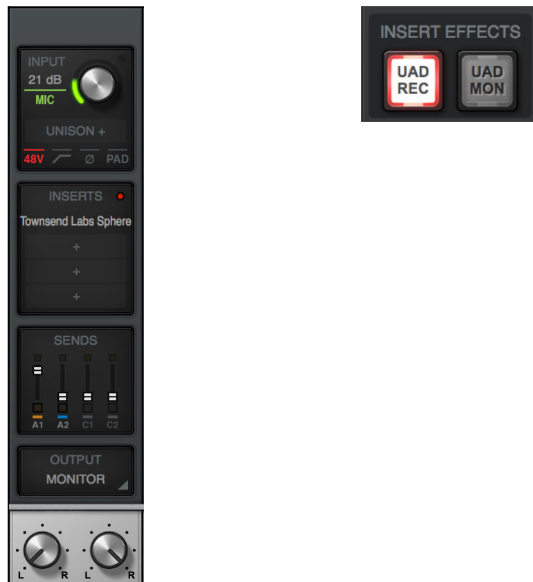
図2-3 Apollo Consoleのチャンネルストリップ画面(右) - Sphereプラグインが最初のスロットに挿入されている状態 Consoleのインサートプラグインモード設定(左) - UAD RECモードがオンになっている状態
