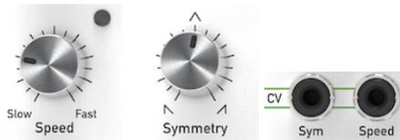
Speed（スピード）ノブはモジュレーション周波数（速度）を操作し、Symmetry（シンメトリー）ノブは変調波形の形を扱います。これらのパラメーターはそれぞれに CV 入力を用意され、外部から制御信号でコントロールすることも可能です。Speed パラメーターでは、CV 信号は Speed ノブの設定値に加算されます。従って CV 信号のみで操作をする場合は Speed ノブを最小の 0 に設定します。また、負数値（逆極）の CV 信号を入力した場合は Speed ノブを最大設定します。CV レンジは 0～8V になります。
