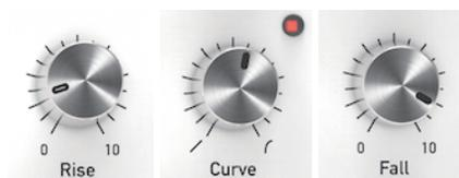
Curve (カーブ) ノブはエンベロープアタックシェイプを設定します。直線から曲線まで連続で設定します。リリース (Fall) 段は常に曲線です。
