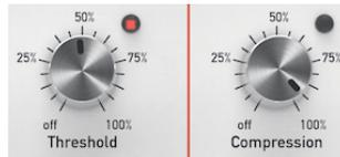
コンプ効果は、一般的なコンプレッサーと同様、Threshold（スレッシュヨルド）とレシオ（= 圧縮比、パネル表記は Compression）によって決定されます。スレッシュヨルドはコンプレッサーが動作する信号レベルを設定します。設定値を超える信号レベルを検知するとコンプレッサーが作動します。レシオはコンプレッサーが動作した際の効果の強さ（深さ）を決定します。設定値が高い程、コンプ効果は強くなり、その分、信号レベルが抑えられます。
