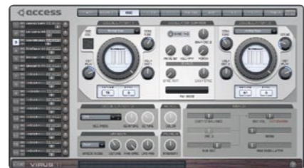
▲オシレーターの操作画面。中央の円内を選択している波形が表示。HyperSawモードでは、波形の代わりにノコギリ波を表す縦線になる。
