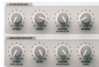
▲フィルター・エンベロープやアンプ・エンベロープなど、音作りのキモの部分を直接コントロール可能。
